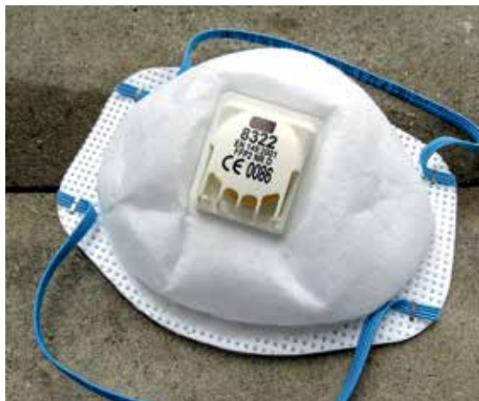
FFP2: Partikel filtrierende Halbmaske mit Ventil zum Ausatmen (kein Schutz vor Gasen u. Dämpfen)
