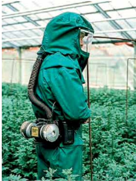
Das Gebläse am Gürtel führt „saubere Luft“ unter die Haube zum Anwender
