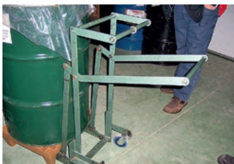
Fasskarre für Paletten zur Verwendung auf festem Boden
