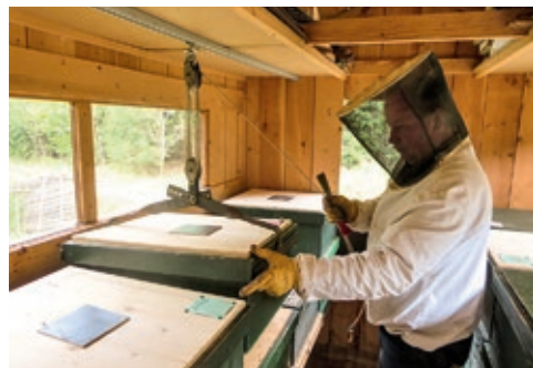
Flaschenzug mit Schienensystem im Deckenbereich des Bienenhauses
