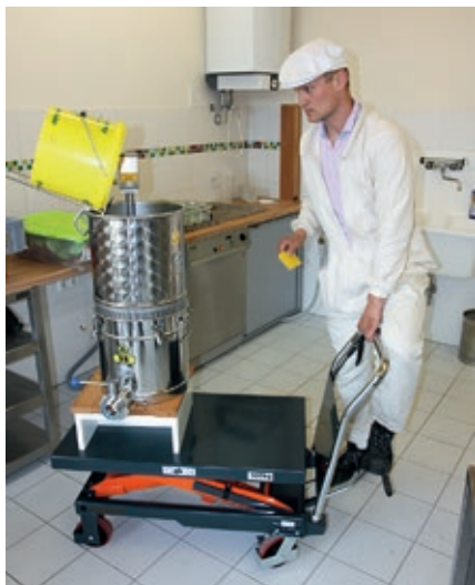
Höhenverstellbarer Arbeitsplatz mittels Hubwagen
