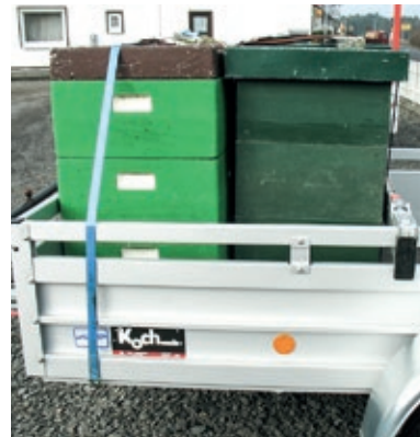
Ladungssicherung am PKW-Anhänger durch Zurrgurten und Klemmbrett
