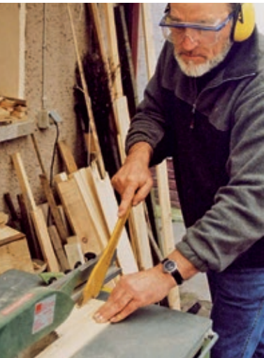
Brettbearbeitung Tischkreissäge mit Schiebstock
