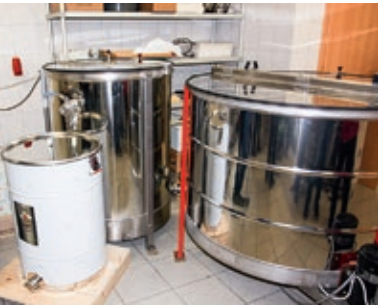
Schleuder mit Zentrifuge und Honigfass
