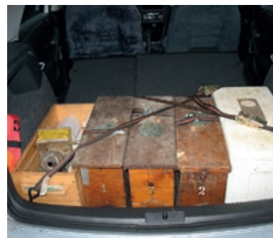
Ladungssicherung im PKW mittels Zurrgurten
