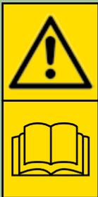
**Bildzeichen** (Piktogramme) an den Maschinen weisen auf Restgefahren hin und geben zusätzliche Informationen zur sicheren Bedienung.
