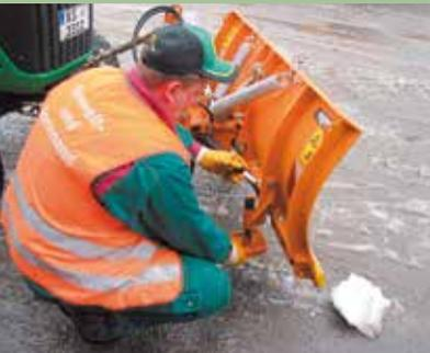
*Sicherung des Räumschildes durch Stützfuß*
