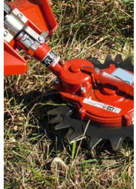
Schleuderarmes Schneidwerkzeug mit gegenläufig arbeitenden Messerblättern
