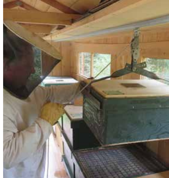
Dank Hebevorrichtung und Laufleiste bewegt der Imker die Beuten rücken-schonend und in aufrechter Haltung.
